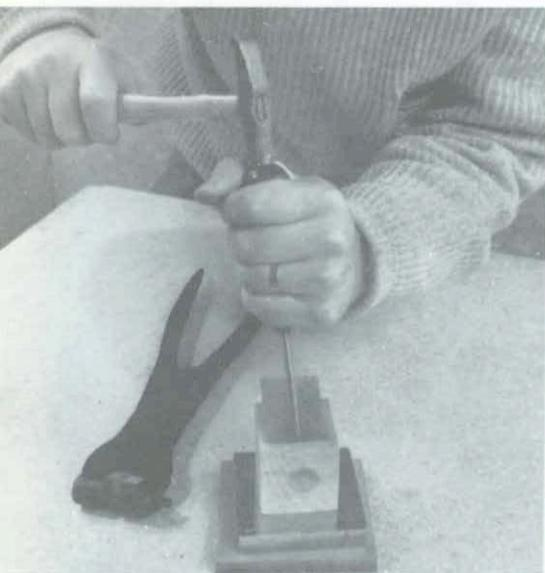
*Perçage au poinçon sur un bloc de bois.*
